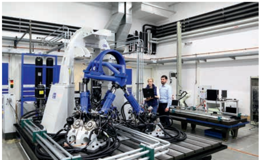
Der am Heinz Nixdorf Institut entwickelte Achsprüfstand mit hydraulischen Hexapoden zur Nachbildung von Straßenanregungen unter Echtzeitbedingungen.
